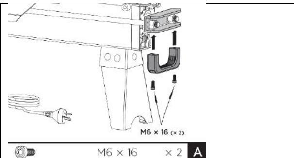
**A. Montáž zvedacího madla:** Připevněte zvedací madlo na U-držák pomocí dvou šroubů M6x16.
