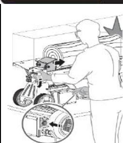
Le dispositif de verrouillage commandé par gâchette est conçu pour empêcher l'abaissement accidentel du levier de commande hydraulique.
