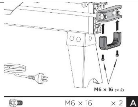
**A. Montaje de la percha de elevación:** Fije la percha de elevación en el soporte en U con dos tornillos M6×16.
