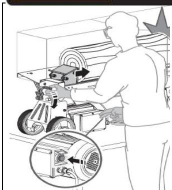
A kioldó vezérlésű reteszelőberendezés célja, hogy megakadályozza a hidraulikus vezérlőkar véletlenszerű leeresztését.
