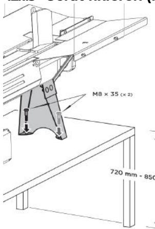
Platzieren Sie den Holzspalter vor der Inbetriebnahme auf einer 72–85 cm hohen, stabilen und planen Werkbank.
