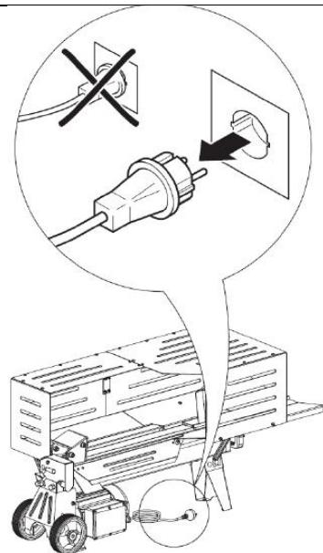
**A. A gép lecsatlakoztatása a hálózatról:** Biztosítsa, hogy a gép már nincs a hálózatra csatlakoztatva, hogy biztosítva van a véletlenszerű bekapcsolás ellen!
