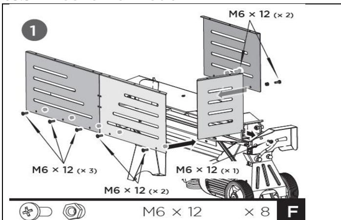
**A. A védőlemezek felszerelése, elől, bal oldalon és hátul:** Rögzítse az előlő védőlemezt, a bal oldali védőlemezt és a két hátsó védőlemezt M6×12 csavarokkal és anyákkal a törzsasztalhoz és a fenéklemezhez (1).
