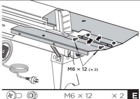
**D. Holzablage rechts und links fixieren:** Verbinden Sie die Holzablagen 1 und 2 mit zwei Schrauben M6×12 und Konter- muttern.
