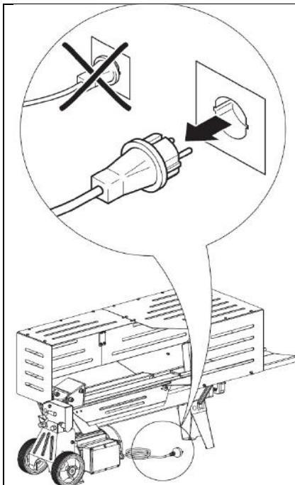
**A. Odvajanje uređaja od strujne mreže:** uvjerite se da uređaj nije spojen na strujnu mrežu i da je osiguran od nehotičnog uključivanja!
