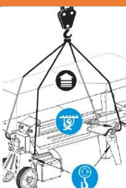
Při použití jeřábu (například při nakládání na nákladní auto) je nutno připojit zdvihací zařízení výhradně na určených místech. Dodržujte platné předpisy týkající se zajištění nákladu!
