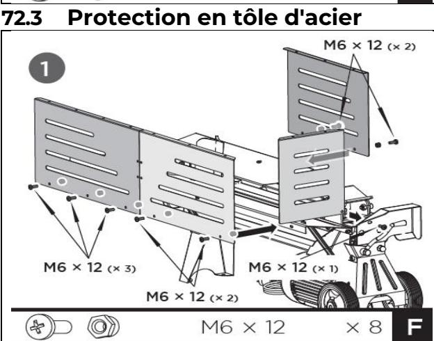
**A. Installer des plaques de protection à l'avant, à gauche et à l'arrière:** Fixez la plaque de protection avant, la plaque de protection gauche et deux plaques de protection arrière avec des vis et écrous M6 × 12 à la table standard et à la plaque de base (1).
