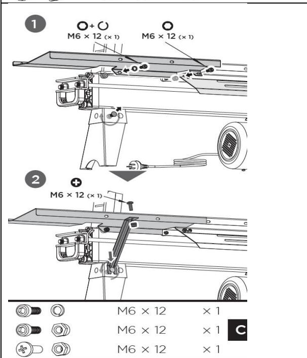
**B. Montáž držáku polene vpravo:** Zarovnejte oba montážní otvory držáku polene na pravé straně s otvory na zadní straně štípače dřeva. Vložte imbusový šroub M6 × 12 a pružnou podložku 6 do montážního otvoru na levé straně, další imbus šroub M6 × 12 a pojistnou matici M6 na pravé straně a oba šrouby utáhněte (1).
