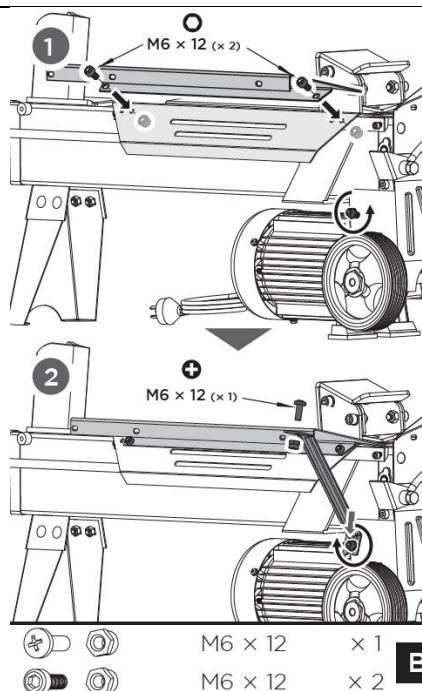
A. A fenéklemez felszerelése: Szerelje fel a fenéklemezt a hátsó vezetőlemezre, majd biztosítsa a két M6x12 hengerfejes csavarral és az ellenanyákkal. Oldja ki a belső kulcsnyílású csavart és a nagy tárcsát a keréktartónál, helyezze a 2-es merevítő nyitott végét a nagy tárcsa és a keréktartó közé, majd húzza meg a csavart. Csatlakoztassa a 2-es merevítő felső végét és a fenéklemezet az M6x12 csillagcsavarral és az M6-os ellenanyával, majd húzza meg azokat.
