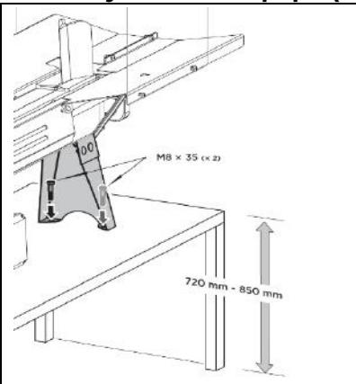
Coloque la rajadora de leña sobre un banco de trabajo estable y plano a unos 72-85 cm de altura, antes de la puesta en marcha. Sujete el pie de apoyo con dos tornillos (M8×35) como se muestra en la figura.
