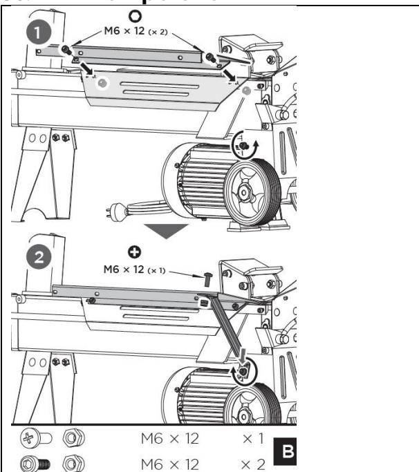
**A. Montáž spodního krytu:** Namontujte desku spodního krytu na zadní vodicí desku a zajistěte ji dvěma šrouby M6 × 12 a pojistnými maticemi. Povolte šroub s vnitřním šestihranem a velkou podložku na podpěře kola, zasuňte otevřený konec podpěrné lišty 2 mezi velkou podložku a podpěru kola a utáhněte šroub. Spojte horní konec vzpěry 2 a spodní kryt křížovým šroubem M6 × 12 a pojistnou maticí M6 a utáhněte je.
