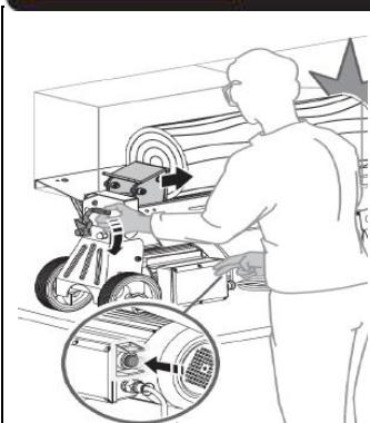
Zaporna naprava kojom upravlja okidni mehanizam konstruirana je tako da se spriječi slučajno spuštanje hidrauličke upravljačke ručice.
