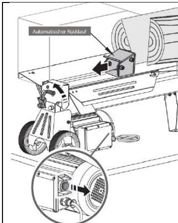
La placa de presión retorna automáticamente a la posición de partida tan solo cuando las dos manos sueltan los elementos de mando.
