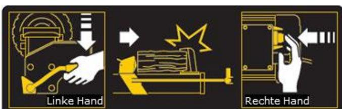
Štípač polen je vybaven dvouručním ovládáním. Zatímco levou rukou ovládáte ovládací páku hydrauliky, pravá ruka ovládá tlakový spínač (viz. obrázek vlevo). Pokud dáte jednu ruku pryč, štípač dřeva „zamrzne“.
