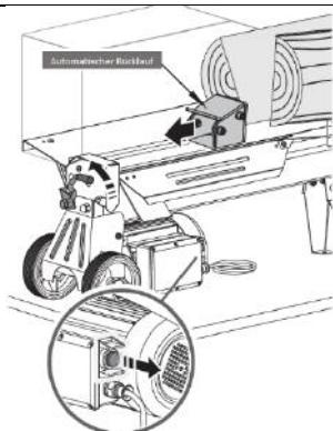
Erst wenn beide Hände die Bedienelemente loslassen kehrt die Druckplatte, selbstständig in die Ausgangsposition zurück.
