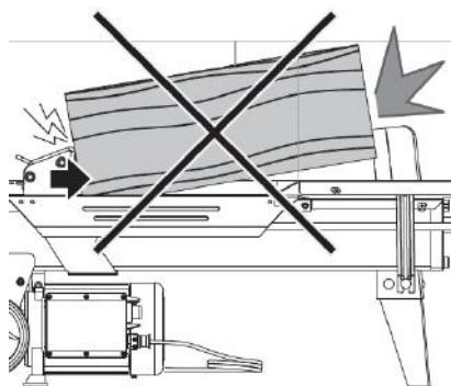
Pazite na to, da se obdelovanec med cepljenjem ne obrača, maje ali zdrsuje. Upoštevajte tudi 5 sekundni časovni limit, ko delujete na stroj s pritiskom.
