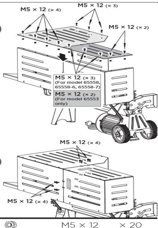
**B. Spajanje gornje i stražnje zaštitne ploče:** obje gornje zaštitne ploče vijcima M5x16 i maticama montirajte na okomite ploče (2). Priključcima za ploče, vijcima i maticama M5x12 (3) spojite gornju i stražnju zaštitnu ploču.
