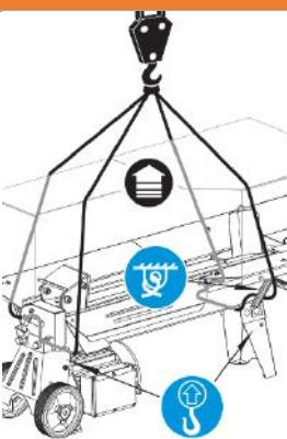
Si levanta con una grúa (p. ej. al cargar en un camión), fije el equipo de elevación únicamente en los puntos previstos para ello.
