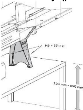
Před uvedením do provozu umístěte štípač na 72 - 85 cm vysoký, stabilní a plochý pracovní stůl.
