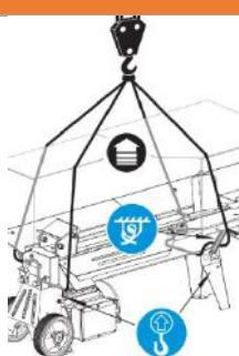
Bei Verwendung eines Krans zum Heben (z.B. beim Verladen auf einen LKW), das Hebezeug ausschließlich an den vorgesehenen Stellen befestigen.
