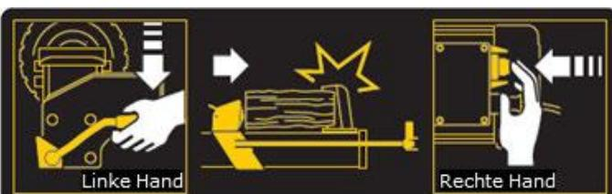
La fendeuse de bûches est équipée d'une commande à deux mains. Tandis que la main gauche actionne le levier de commande hydraulique, la main droite commande le pressostat (voir figure à gauche). Si vous retirez une main, la fendeuse de bûches "se fige".
