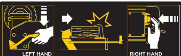
Štiepačka polien je vybavená dvojručným ovládaním. Kým ľavou rukou ovládate ovládaci páku hydrauliky, pravá ruka ovláda tlakový spínač (vid. obrázok vľavo). Ak dáte jednu ruku preč, štiepač dreva "zamrzne".
