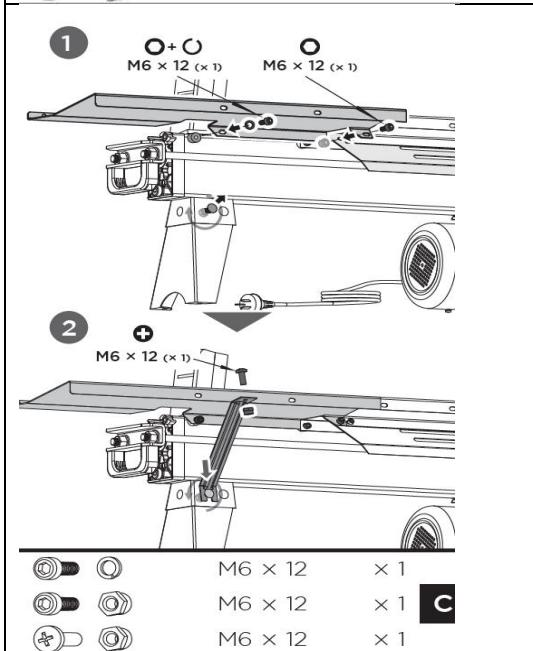
**B. Montaža odlagalne mize na desni strani:** Poravnajte obe pritrditveni odprtini odlagalne površine na desni strani z odprtinama na zadnji strani cepilnika. Vstavite en imbus vijak M6×12 in vzmetni obroček 6 v montažno odprtino na levi strani. Drug imbus vijak M6×12 in zaporno matico M6 vstavite na desni strani in oba vijaka zategnjite (1).
