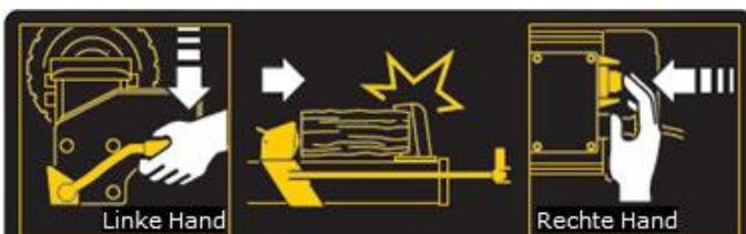
A fahasító gép kétkezes vezérléssel van ellátva. Míg bal kézzel a hidraulikus vezérlőkart, a jobb kezével a nyomáskapcsolót működtetheti (lásd a bal oldali ábrát). Ha elveszi az egyik kezét, a fahasító gép „lefagy”.
