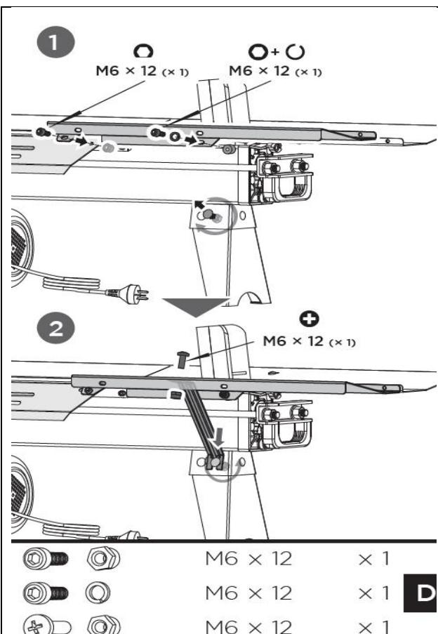
**C. Montez l'étagère en bois à gauche:** Alignez les deux trous de montage à gauche de l'étagère en bois avec les trous à l'avant de la fendeuse de bûches. Insérez une vis Allen M6 × 12 et une rondelle élastique 6 dans le trou de montage sur le côté droit, une autre vis Allen M6 × 12 et un contre-écrou M6 sur le côté gauche et serrez les deux vis.
