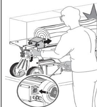
Blokovacie zariadenie riadené spúšťou je navrhnuté tak, aby sa zabránilo neúmyselnému spusteniu hydraulické ovládacie páky.
