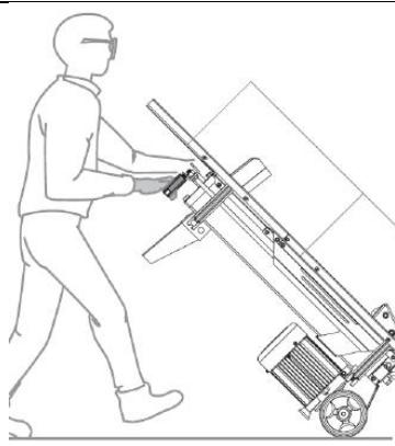
Za pomicanje stroja za cijepanje na kraće udaljenosti uhvatite ga za transportnu dršku i lagano ga nagnite.
