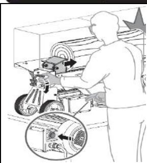
El dispositivo de bloqueo controlado por el activador está diseñado para evitar un descenso accidental de la palanca hidráulica de control.
