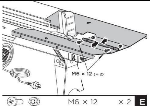
**E. Spojenie držiaka polien vľavo a vpravo:** Spojte držiak polien 1 a 2 pomocou dvoch skrutiek M6 × 12 a poistných matíc.
