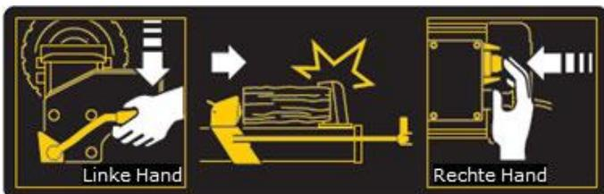
Der Holzspalter ist mit einer Zweihandsteuerung ausgestattet. Während die linke Hand den hydraulischen Steuerhebel betätigt, steuert die rechte Hand den Druckschalter (s. Abbildung links). Nimmt man eine Hand weg, „friert“ der Holzspalter ein.
