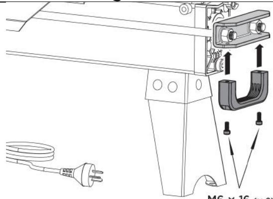
A. **Hebebügel montieren:** Befestigen Sie den Hebebügel mit zwei M6x16 Schrauben an der U-Halterung.
