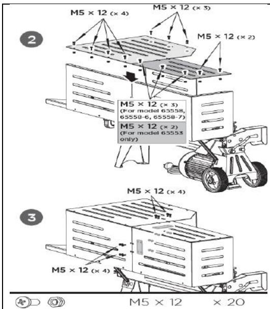
**B. Spajanje zgornje in zadnje zaščitne plošče:** Montirajte obe zgornji zaščitni plošči z vijaki M5x16 in maticami na vertikalni plošči. Spojite zgornji in zadnji zaščitni plošči s pomočjo ploščatih priključkov, vijakov in matic M5x12 (3).
