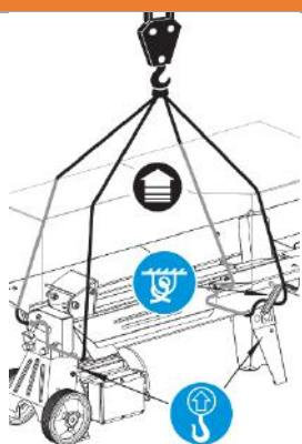
Lorsque vous utilisez une grue pour le levage (par exemple lors du chargement sur un camion), attachez le palan uniquement aux endroits désignés.
