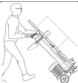
Pour déplacer la fendeuse de bûches sur de courtes distances, saisissez la poignée de transport et inclinez-la légèrement.
