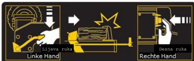
Stroj za cijepanje drva ima dvoručno upravljanje. Dok lijeva ruka upravlja hidrauličkom upravljačkom ručicom, desna ruka upravlja tlačnim prekidačem (v. slika lijevo). Ako maknete jednu ruku, stroj za cijepanje drva odmah prestaje raditi.
