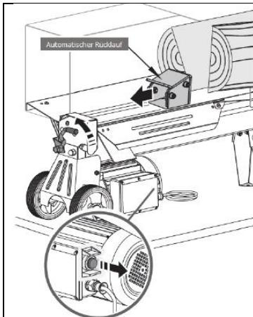
Ce n'est que lorsque les deux mains relâchent les commandes que le plateau de pression revient automatiquement à sa position d'origine.
