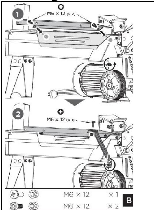
**A. Montaža spodnje zaščitne plošče:** Montirajte spodnjo zaščitno ploščo na zadnjo vodilno ploščo in jo zavarujte z dvema cilindričnima vijakoma M6×12 in z zapornimi maticama. Odvijte imbus vijak in veliko podložko na držalu kolesa, vstavite odprt konec opornika 2 med veliko podložko in držalo kolesa ter trdno privijte vijak. Spojite zgornji konec opornika 2 in spodnjo zaščitno ploščo s pomočjo vijaka s križno zarezo M6×12 in zaporne matice M6. Nato zategnite zaporno matico.
