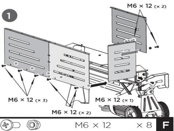
**A. Montaje de las placas de protección delante, a la izquierda y detrás:** Fije en la mesa central y en la placa inferior (1) la placa delantera de protección, la placa de protección izquierda y las dos placas traseras con tornillos M6×12 y tuercas.
