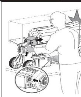
Blokovací zařízení řízené spouští je navrženo tak, aby se zabránilo neúmyslnému spuštění hydraulické ovládací páky.
