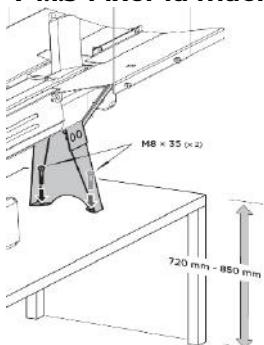
Placez la fendeuse de bûches sur un établi de 72 à 85 cm de hauteur, stable et plat avant la mise en service.
