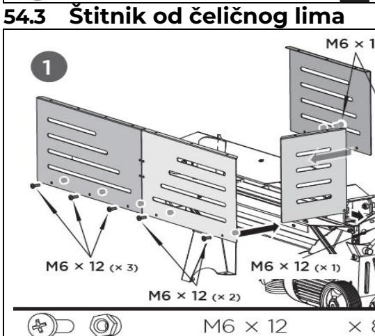
**A. Montaža zaštitne ploče s prednje, lijeve i stražnje strane:** prednju zaštitnu ploču, lijevu zaštitnu ploču i dvije stražnje zaštitne ploče vijcima M6×12 i maticama pričvrstite za glavni stol i podnu ploču (1).
