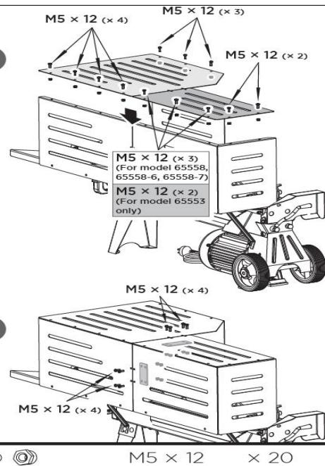
**B. Conexión de las placas de protección superior y trasera:** Monte en las placas verticales (2) las dos placas de protección superiores con los tornillos M5×16 y tuercas.
