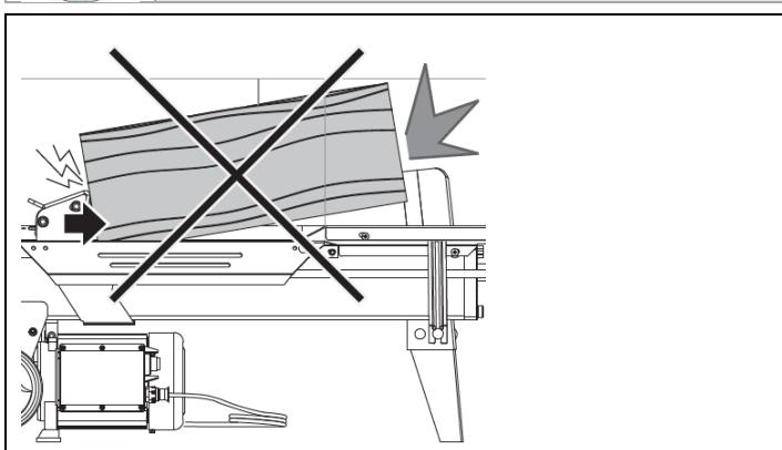
Ujistěte se, že se poleno při štípání neprotáčí a neklouže. Dbejte i na 5 sekundový časový limit pro aplikaci tlaku.
