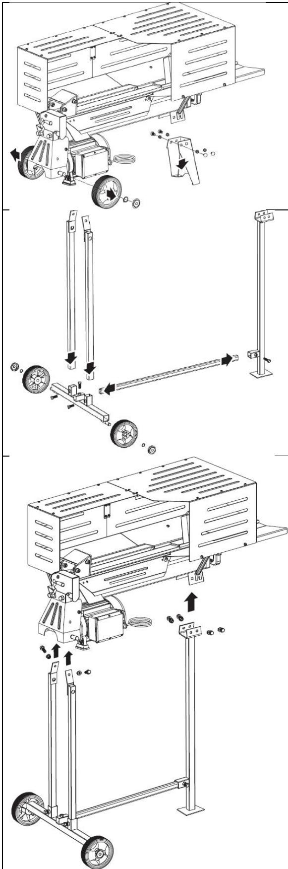
**B. Uklanjanje kotača i potporne noge:** demontirajte kotače (14) i potpornu nogu (16).
