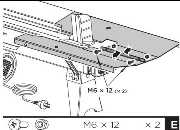
**D. Fijación de la balda de la madera a derecha e izquierda:** Una las baldas de la madera 1 y 2 con dos tornillos M6×12 y contratuercas.
