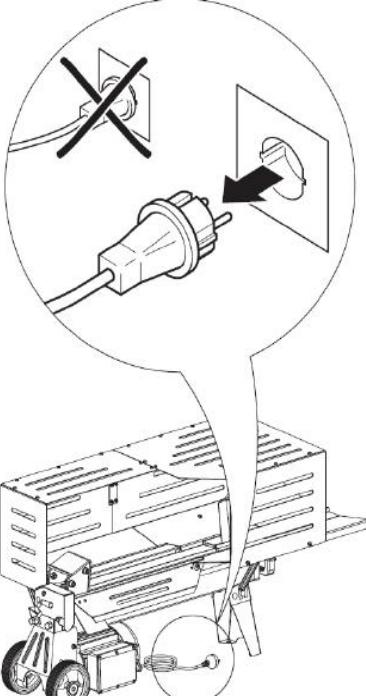
**A. Odpojte zariadenie od siete:** Uistite sa, že zariadenie nie je pripojené k sieti a je zabezpečené proti náhodnému zapnutiu!
