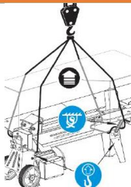
Ha a gép emeléséhez darut használ (pl. tehergépkocsira történő felrakáskor), csak az arra kijelölt helyekre akassza az emelőszerkezetet.
