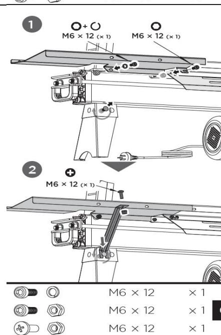
**B. Montaje de la balda de la madera a la derecha:** Alinee los dos orificios de sujeción de la balda de la madera a la derecha con los agujeros del dorso de la rajadora de leña. Coloque un tornillo allen M6×12 y una arandela elástica del 6 en el orificio de montaje del lateral izquierdo, otro tornillo allen M6×12 y contratuerca M6 a la derecha y apriete ambos tornillos (1).
