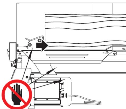
Toujours diviser les blocs de bois horizontalement dans le sens du grain.
