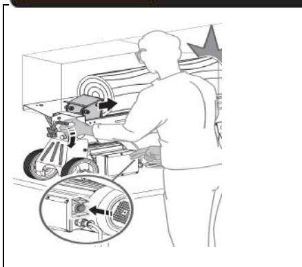
Zapiralni mehanizem, ki deluje preko sprožilca, je zasnovan tako, da preprečuje možnost, da bi rokovalec po nesreči spustil hidravlično krmilno ročico.
