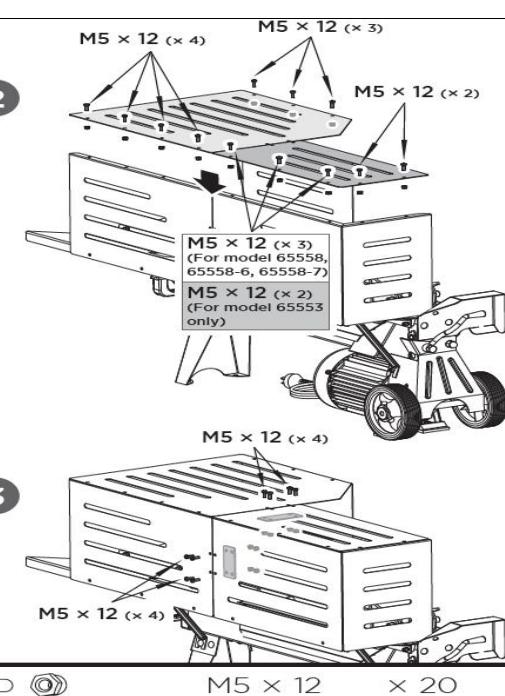
**B. Spojení horního a zadního krytu:** Namontujte oba horní kryty na svislé desky (2) pomocí šroubů M5x16 a matic. Spojte horní a zadní desky krytů pomocí spojovacích dílů, šroubů a matic M5x12 (3).
