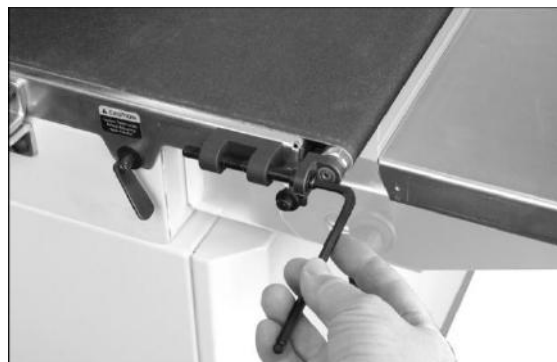
Figure 8-2: Réglage tension de courroie
