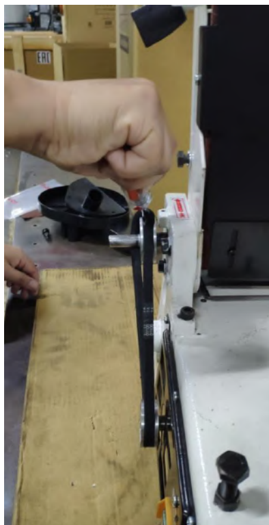
3. Riemen anziehen bis er in der Rille sitzt.
