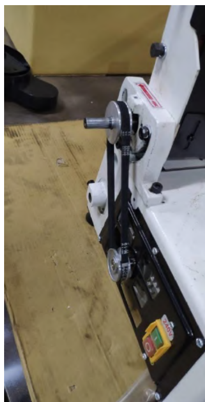
4. La forte tension de la courroie entrainera parfaitement la bande abrasive
