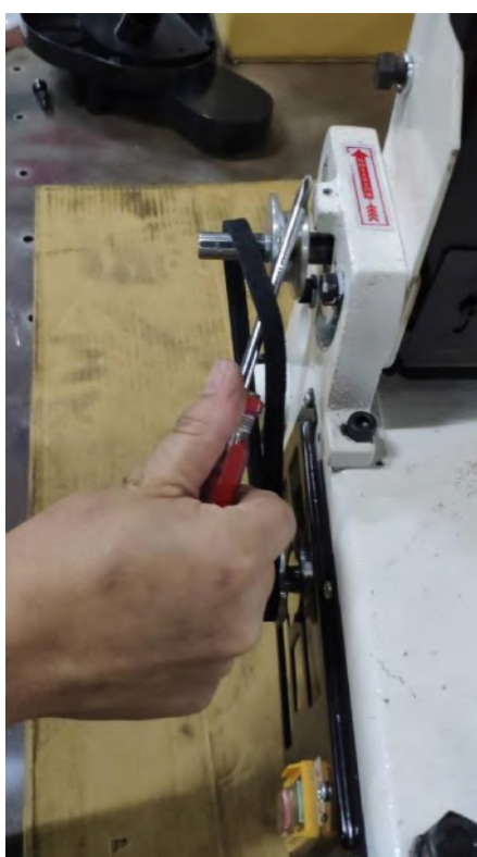
2. A l'aide d'un tournevis, tendez la courroie vers la seconde poulie
