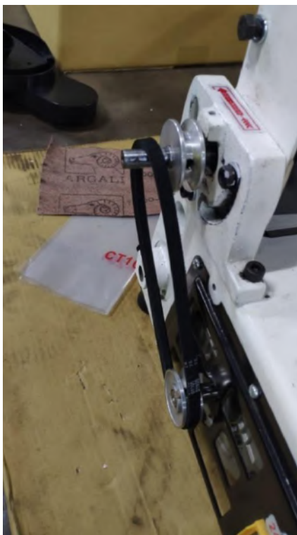
1. Montieren Sie den Antriebsriemen auf die Motorriemenscheibe.
