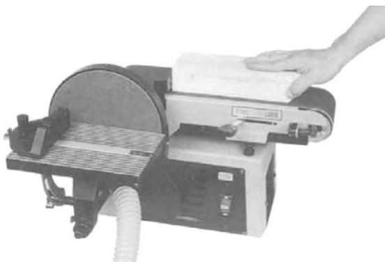
Figure 9-2: Ponçage à plat
