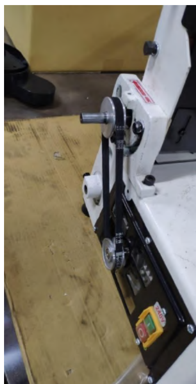
4. Die hohe Spannung des Riemen treibt dann das Schleifband an.
