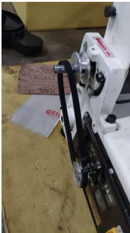
1. Monter la courroie sur la poulie moteur
