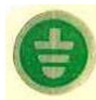
Figure 9 : notification de mise à la terre
