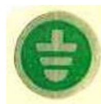
Figure 9 : notification de mise à la terre
