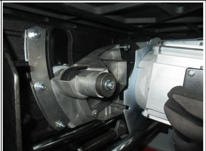
Der Motor kann nun abgenommen werden und mit der Verkabelung am Boden abgelegt werden.
